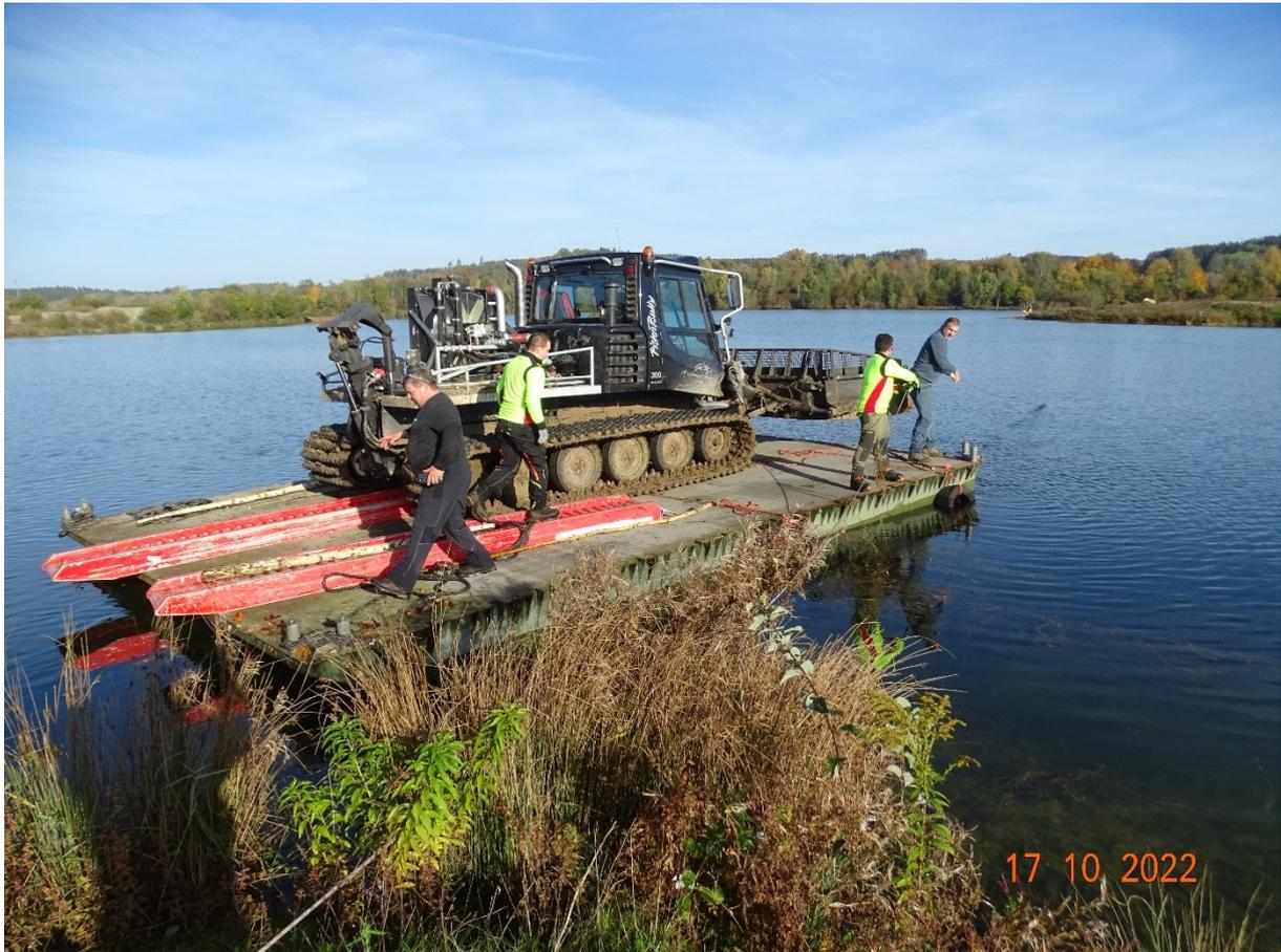
Das 10 to schwere Fahrzeug konnte relativ schnell auf die Insel befördert werden, indem man die Plattform samt Bully an einem über den See gespannten Kletterseil hinüberzog.
